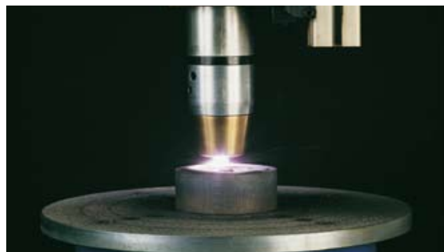
Figura 31 Processo de deposição por PTA
