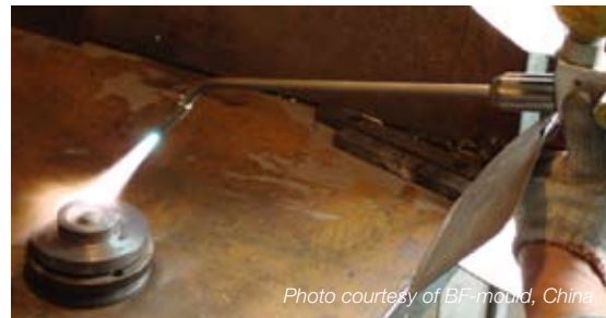
Figura 19 Finas camadas minimizarão a oxidação
